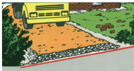
仮設砂利道の排水と土質分離
